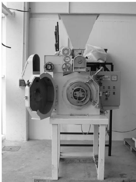
Figura 6 – Pellettizzatrice a trafila cilindrica verticale impiegata nei test
