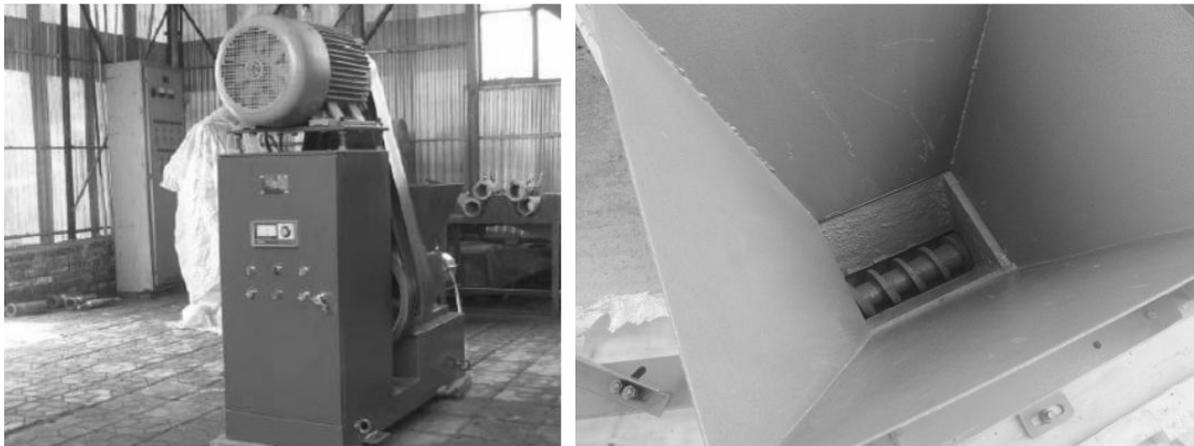
Figura 9 - Bricchettatrice GCB15: Vista frontale del quadro elettrico (sx) e particolare della tramoggia (dx)
