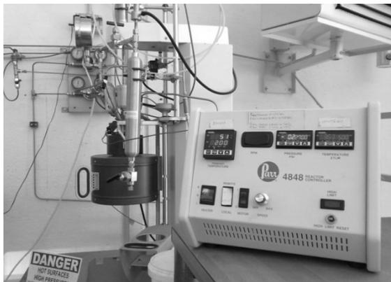
*Figura 5 – Reattore utilizzato per i test di torrefazione*
