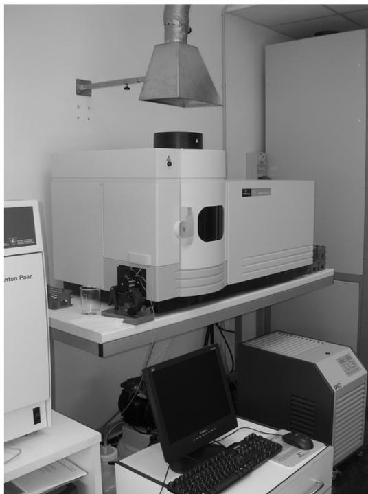
Figura 3 – Spettrometro impiegato per la determinazione di P, Na, K, Mg, Ca.
